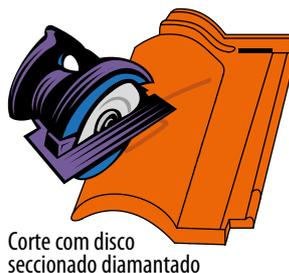
Corte com disco sectionado diamantado
